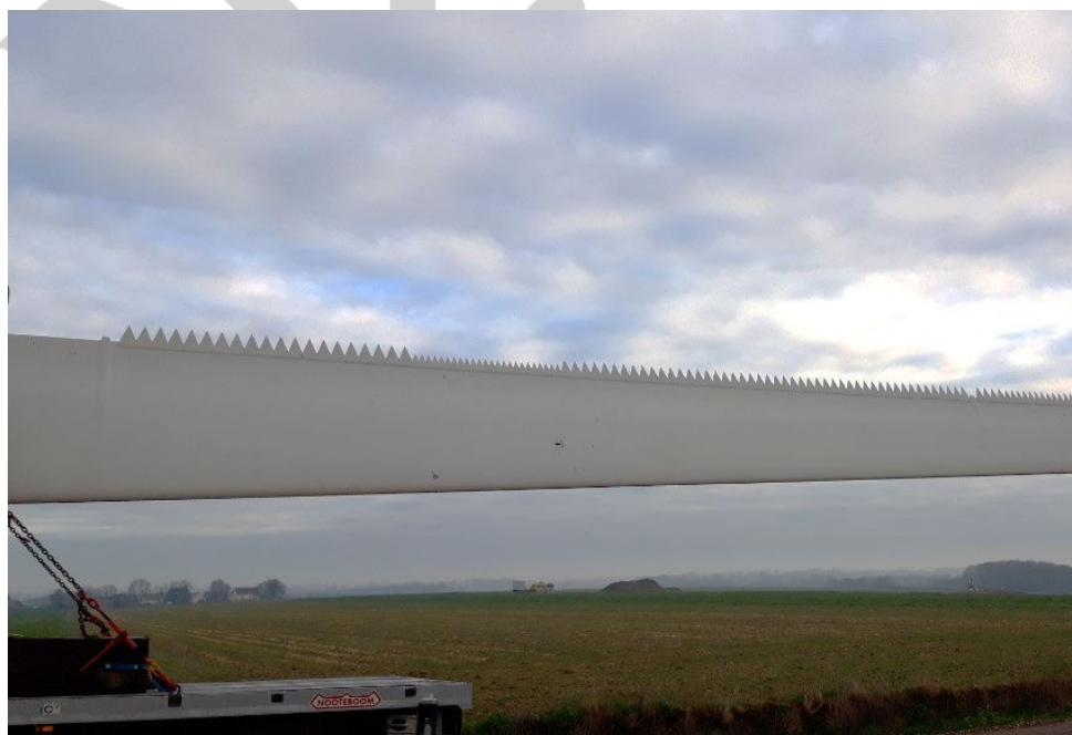
Figure 1 : Peigne sur des pales d'une éolienne Nordex N117-3,6MW - Seider
